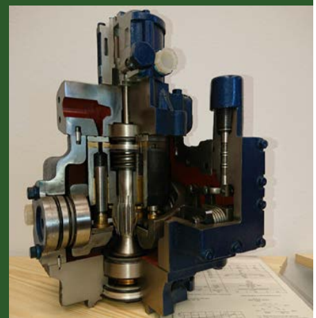
Rez regulačného piestového hydrogenerátora s naklonenou doskou
