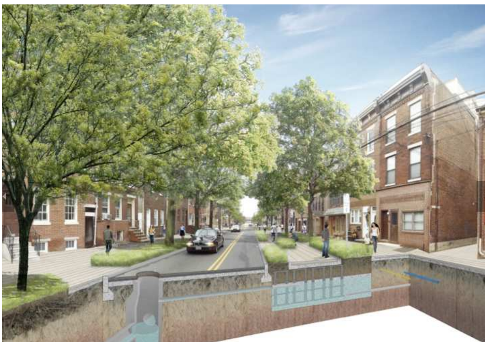
Obr.21 Modelové riešenie drenážnych systémov v uličnej zástavbe
