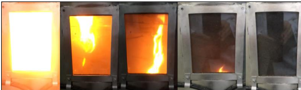
Obr. 17 Vývoj plameňa zaznamenaný v priebehu výbuchu vo VK 100
