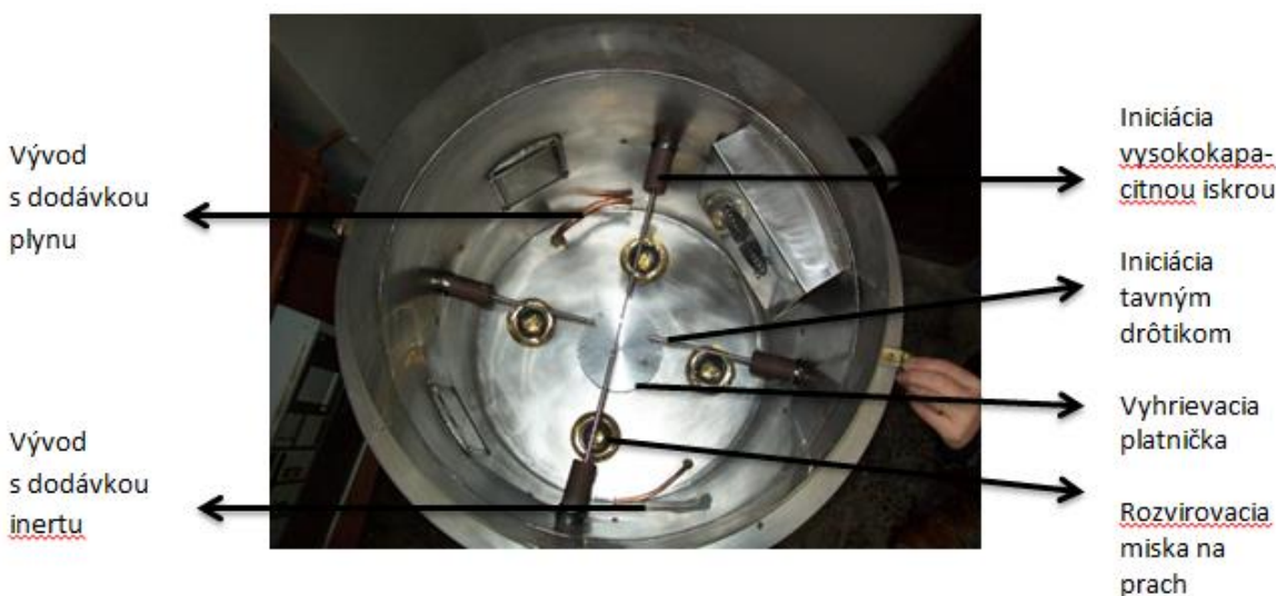
Obr. 19 Vnútorý priestor VK 100 s vývodom s dodávkou plynu a iniciátorom tavným drôťkom pre horľavé plyny
