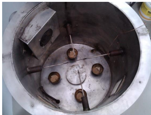
Obr. 8 Pohľad na dno pripravenej výbuchovej komory
