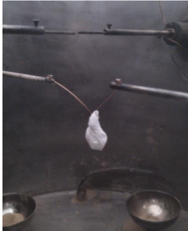
Obr. 7 Pohľad do pripravenej výbuchovej komory cez priezor z tvrdeného skla
