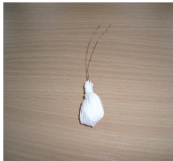
Obr. 14 Pripravený iniciačný zdroj (elektrický palník, nitrocelulóza, šetrič tabaku)
